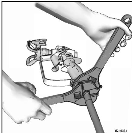
3. Надежно затяните с помощью гаечных ключей.
