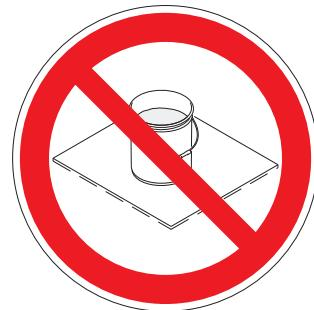
**Всегда заземляйте металлическую емкость.** Подсоедините к емкости провод заземления. Подсоедините один конец к емкости с помощью зажима, а второй – к точке истинного заземления, например к трубе для подачи воды.
