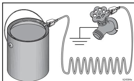
**Для обеспечения электропроводности цепи заземления при промывке распылителя или снятии давления выполните следующие действия.** Плотно прижмите металлическую часть распылительного пистолета к боковой поверхности заземленной металлической емкости и нажмите пусковой курок пистолета.
