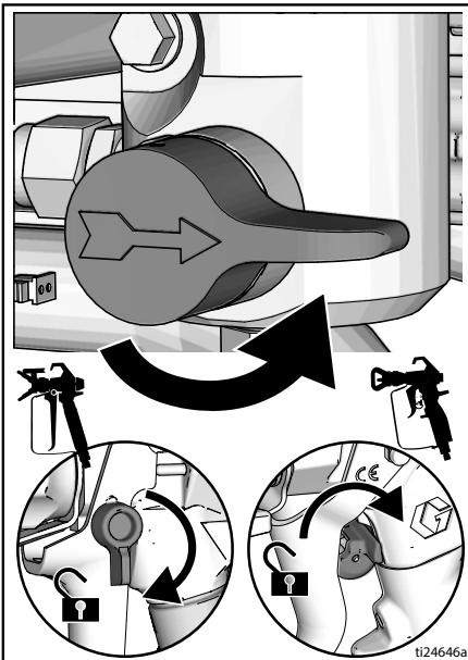
16. Плотно прижмите металлическую часть пистолета к заземленной металлической емкости. Нажмите пусковой курок пистолета и осуществляйте промывку до полной очистки устройства.
