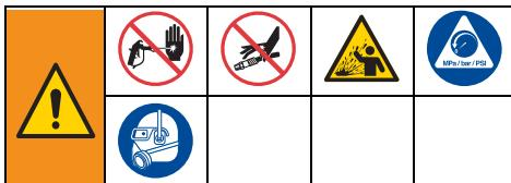
Это оборудование будет оставаться под давлением до тех пор, пока давление не будет снято вручную. Во избежание получения серьезной травмы, вызванной жидкостью под давлением (например, в результате прокола кожи, разбрызгивания жидкости и контакта с движущимися деталями), выполняйте процедуру снятия давления после каждого завершения распыления и перед очисткой, проверкой либо обслуживанием оборудования.
