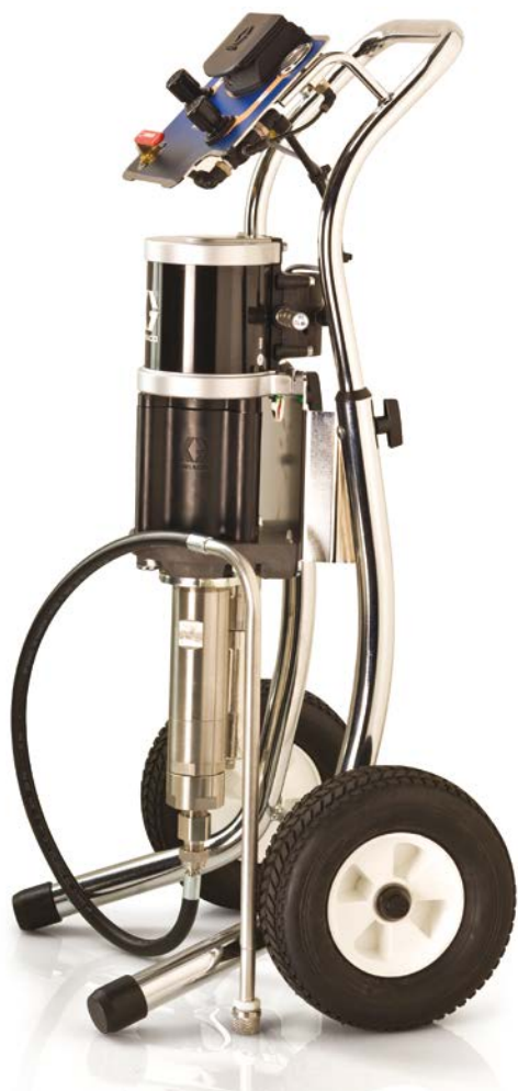
Установка комбинированного распыления на тележке
