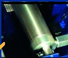
**Цилиндр автоматического разгрузчика.** Предотвращает выброс материалов, влияющий на качество отделки. Большая степень комфорта за счет мягкости пуска при каждом нажатии на курок.
