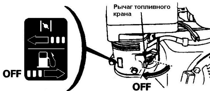
Рисунок 12 – Рычаг топливного крана в положении "OFF" ("Выключено")
