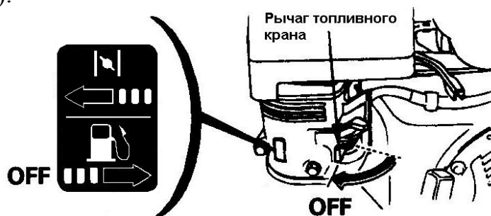
Рисунок 12 – Рычаг топливного крана в положении "OFF" ("Выключено")
