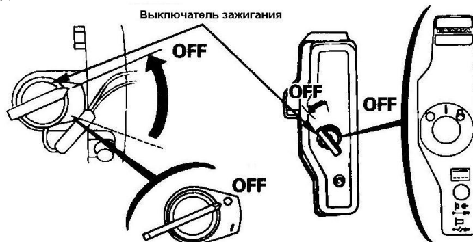
Рисунок 11 – Выключатель зажигания в положении "OFF" ("Выключено")
