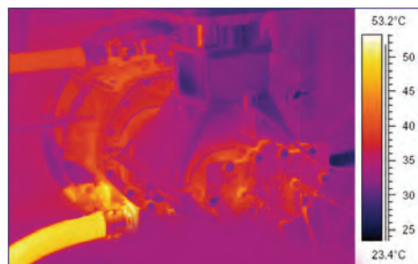
Ограниченное увеличение температуры в элементе сжатия компрессора только на 25°C
